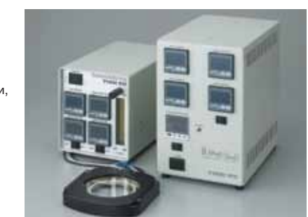
Камера управления температурой и концентрацией CO 2 (слева) Камера управления температурой и концентрацией CO 2 с устройством смешивания (справа)
