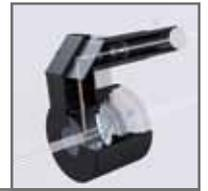
Этот адаптер использует зеркало для совмещения оси света, освещающего объект, с оптической осью объектива. Количество обычного отраженного света увеличивается и это используется для наблюдения в светлом поле.
