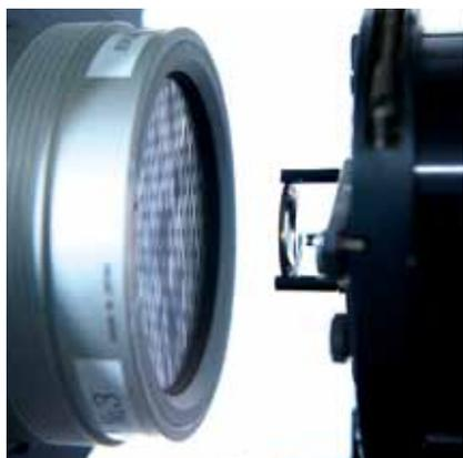
Контроль шероховатости поверхности интерферометром
