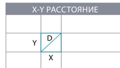
Продольное (X-направление), поперечное (Y-направление) и диагональное (D-направление) расстояние четырехугольника, сформированного четырьмя координатными осями (две в X-направлении и две в Y-направлении) может быть измерено за одно действие.
