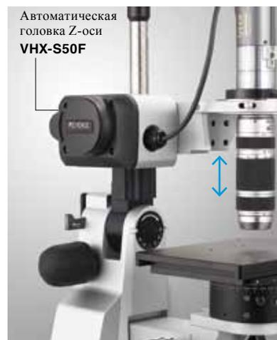
Автоматическая головка Z-оси VHX-S50F
