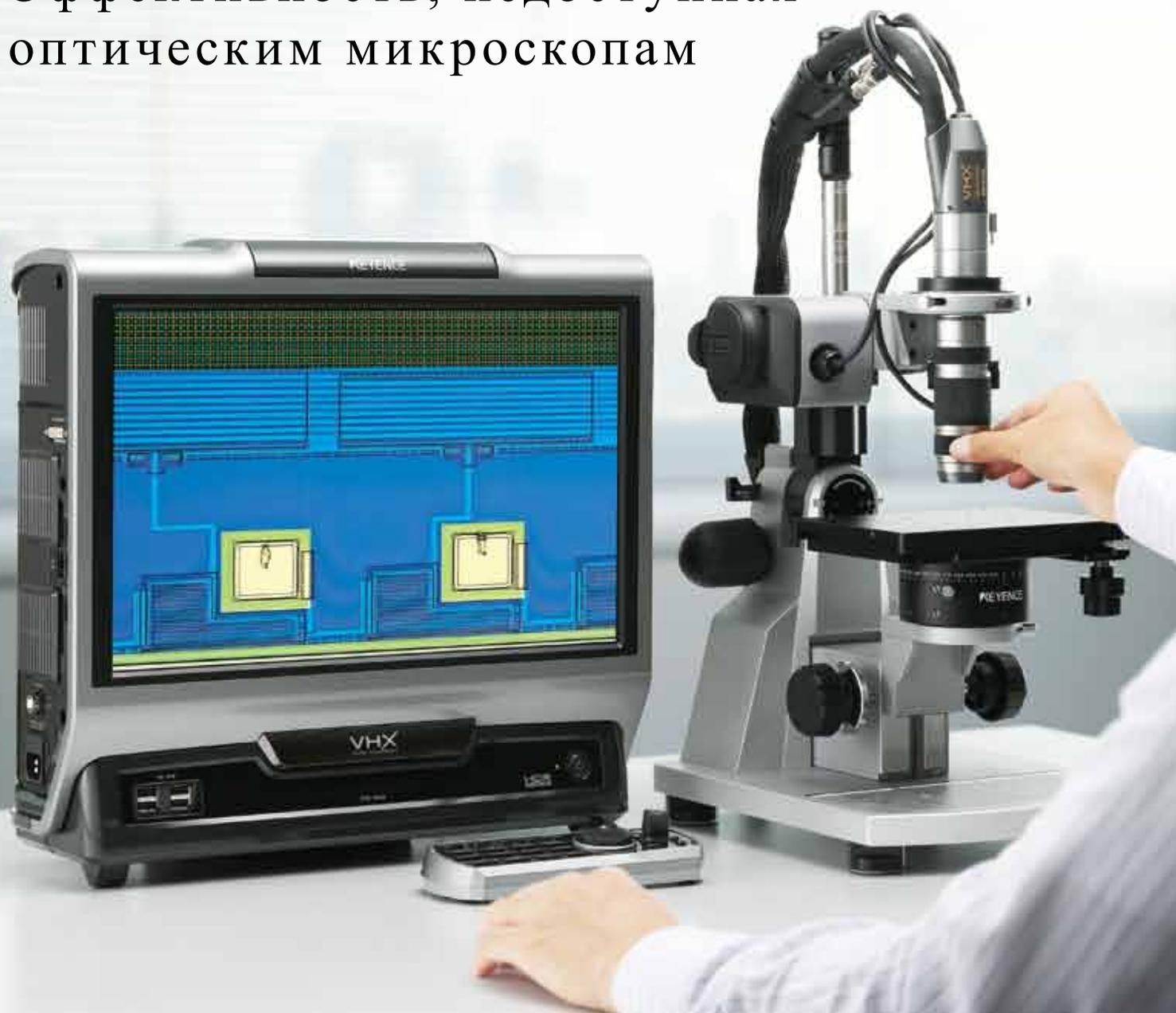
**VHX-1000 объединяет продвинутовую функциональность и лучшие среди прочих возможности изображения и измерения.**
