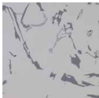
Шлифованный образец AlSi
