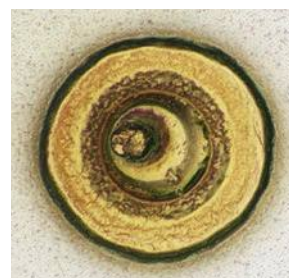
Выпуклость стержня на интегральной микросхеме
