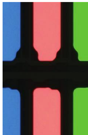
Матрица TFT затемнена из-за яркости цветного фильтра.
