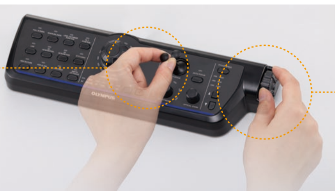
Быстрое перемещение оптической головки вращением фокусирующей ручки
