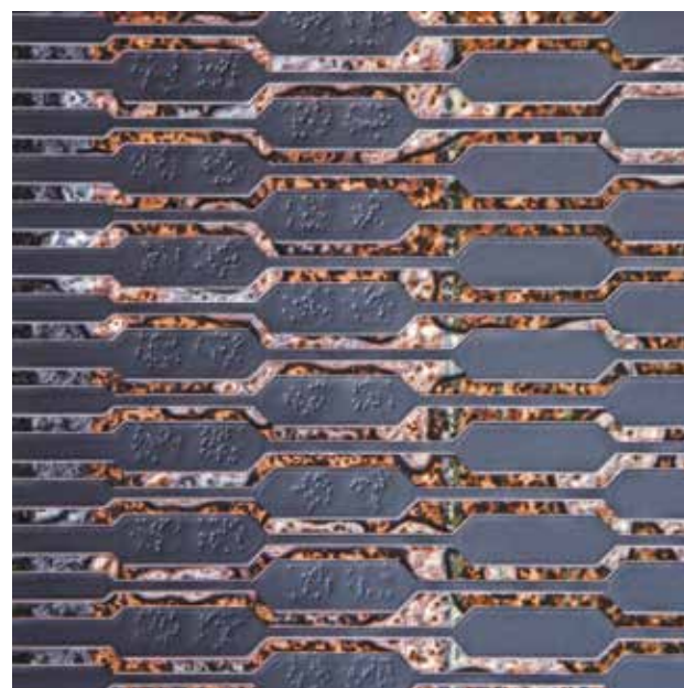
Анизотропная проводящая пленка (ACF) на участке жидкокристаллического дисплея
